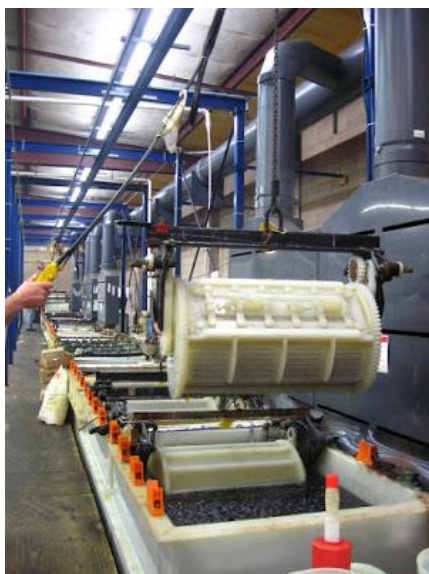
ציפוי אלקטרוליטי בחביות. המקור: Diversified. Online Company Magazine. http://dfsusa.blogspot.com/2016/11/new-electroplating-line.html
