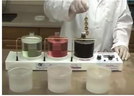
ציפוי תכשיטים בזהב. המקור: Gold Plating Services. Gold Plating Kit - Immersion Electroplating.
