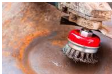
הורדת חלודה באמצעות הברשה. המקור: STELMA T.S.A. Shipbuilding and Dry- [7] docking.
