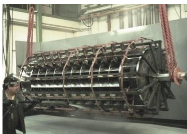
הוצאת חלק מעובד מאמבטיית ליטוש ושטיפתו בריסוס. המקור: Poligrat Deutschland GmbH. https://www.poligrat.de/home/index.php?secti
