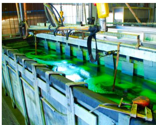
ליטוש אלקטרוכימי באמבטיה. המקור: Electro Polish Co. Electropolish. https://electro-polish.com/processes/electropolish
