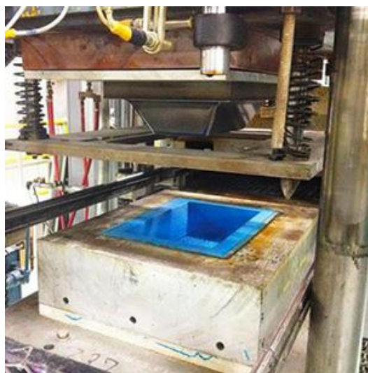
איור 4 : יצור מוצר פלסטי בשיטת כבישה http://aaglobalimports.com/services/
