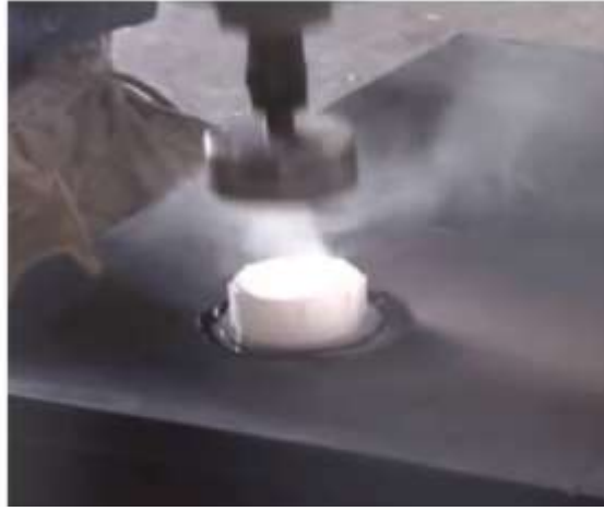
תהליך ריתוך ספין (סיבובי). המקור: KOOok Production. Spin Welding Tutorial
