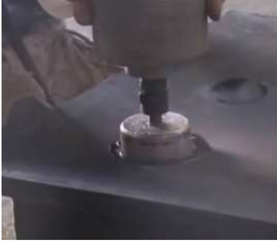
תהליך ריתוך ספין (סיבובי). המקור: KOOok Production. Spin Welding Tutorial
