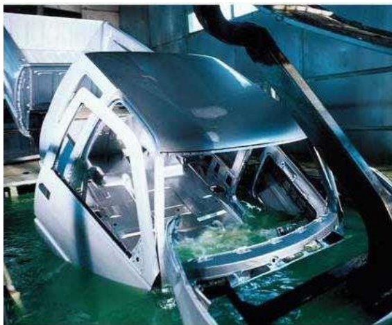
ציפוי אבץ פוספט לגוף של מכונית. המקור: PF Product Finishing. Pretreatment for Painting. https://www.pfonline.com/articles/pretreatment-for-painting
