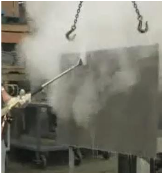
שטיפה ופוספטציה באמצעות ריסוס אדים. המקור: Electro Steam. Electric Steam Generators for Cleaning and Phosphatizing. https://www.youtube.com/watch?v=l2M14J66kbq
