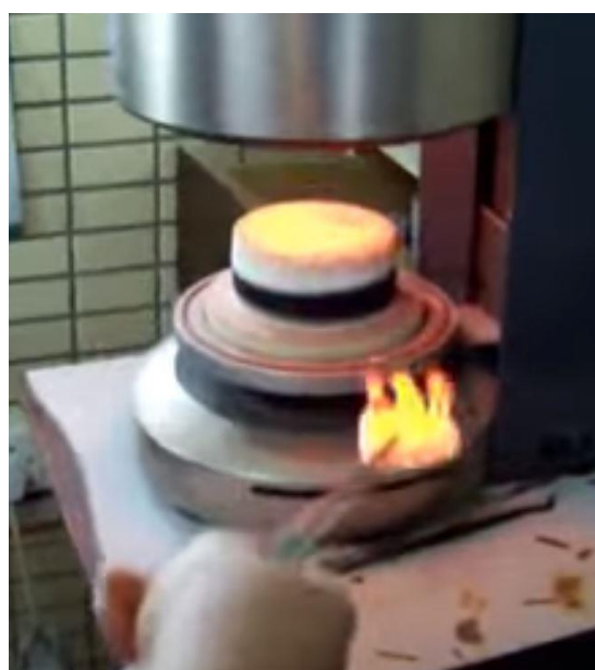
כתרי חרסינה לאחר "אפיה" בתנור. מקור התמונה: Baot China. Process of Porcelain Build- Up Complete PFM- Ceramics. YouTube, Marth 2014. https://www.youtube.com/
