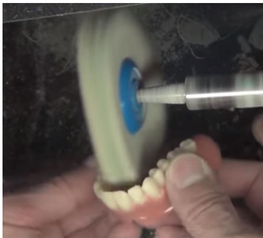
גימור תותבת מפולי מתיל מתאקרילט. מקור התמונות. Kulzer. Finishing and polishing (EN). May 2018. https://www.youtube.com/
