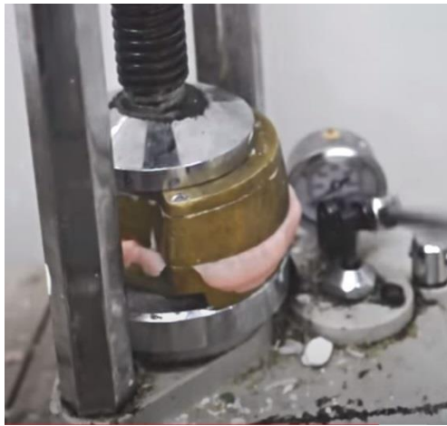
הפעלת לחץ מכאני על התבנית – כבישה. מקור התמונה: GDDoi Photographer. Flasking procedure. YouTube, June 2014. https://www.youtube.com/
