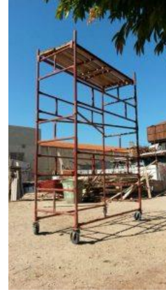
פיגום עצמאי נייד. המקור: גולד ליין פתרונות לעבודות בגובה בע"מ. http://www.goline.co.il
