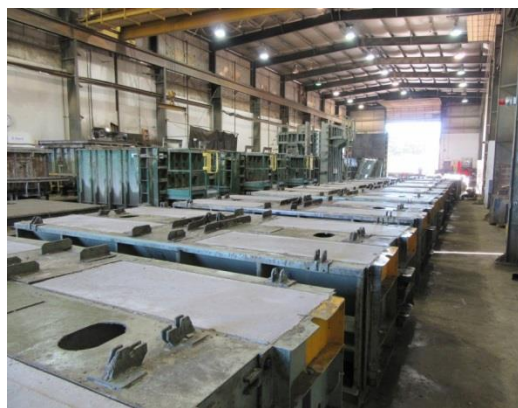
קו לייצור רכיבים טרומיים. המקור: Concrete Construction. Precast & Block Production. Smith-Midland. Lean Manufacturing in Precast Concrete.
