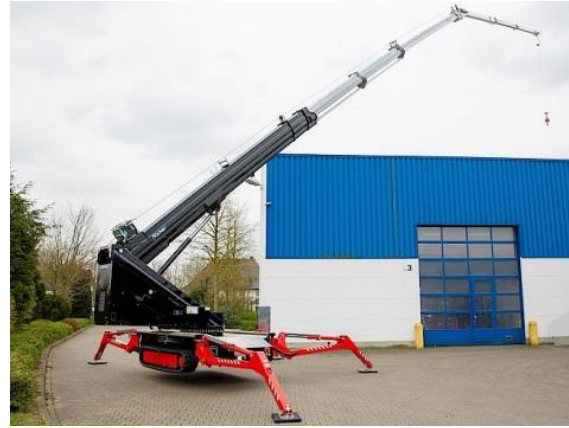
עגורן נייד מתנייד על גבי זחל. מקור התמונה: שיא Trailer Crane. – עגורן נייד – http://www.clift.co.il/
