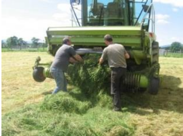
ניקוי סתימה מקצרה. מקור התמונה: Clearing Blockages Safely on Agricultural Machinery https://www.hsa.ie/
