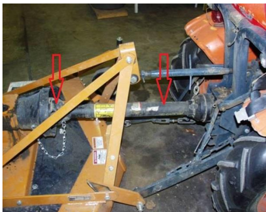
מעביר הכוח של טרקטור עם גידור לבטח של הציר הקרדני המסתובב בזמן הפעלת המכונה. המקור: Extension. Power Take-Off Safety. https://articles.extension.org/
