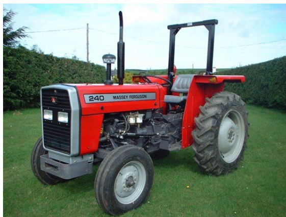
מסגרת הגנה על מפעיל הטרקטור בזמן התהפכות טרקטור. המקור: Tractors Info. Massey Ferguson 240 Tractors Price List. https://tractorsinfo.com/
