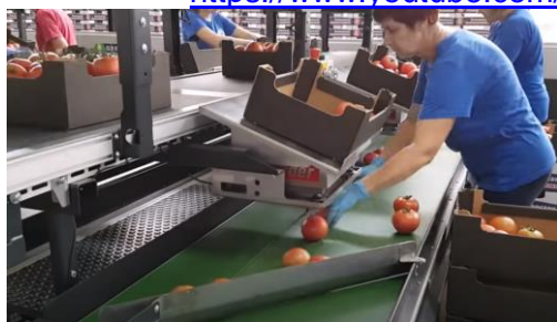
המערכת של מיון אופטי מסירה את העגבנייה הלא בשלה מהמסלול. מקור התמונה: TOMRA. Tomato sorting machine Sentinel II - TOMRA Sorting. YouTube. May 2016. https://www.youtube.com/
