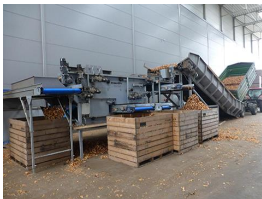
קליטה יבשה של בצל וניקוי ראשוני שלו במערכת. מקור התמונות: Haith Group. Packhouse Equipment – Onions & Red Beet. https://www.haith.co.uk/
