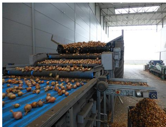
קליטה יבשה של בצל וניקוי ראשוני שלו במערכת. מקור התמונות: Haith Group. Packhouse Equipment – Onions & Red Beet. https://www.haith.co.uk/
