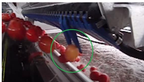
המערכת של מיון אופטי מסירה את העגבנייה הלא בשלה מהמסלול. מקור התמונה: TOMRA. Tomato sorting machine Sentinel II - TOMRA Sorting. YouTube. May 2016. https://www.youtube.com/
