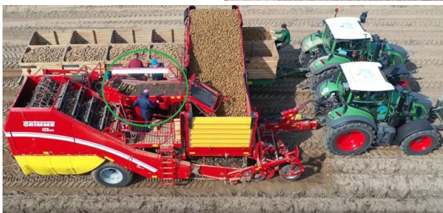
ניקוי ראשוני של תפוחי אדמה בשדה – ניקוי ידני ליד חלקים נעים. מקור התמונות: AgrarBlick. Kartoffelernte 2019 in Niedersachsen - Einblick in den Betriebsablauf - Potato https://www.youtube.com/ harvest in Germany 4K. YouTube, September 2019.
