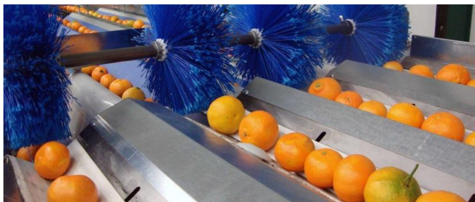
ניקוי יבש באמצעות מברשת. מקור התמונה: Futura. Fruit Sorting Equipments.
