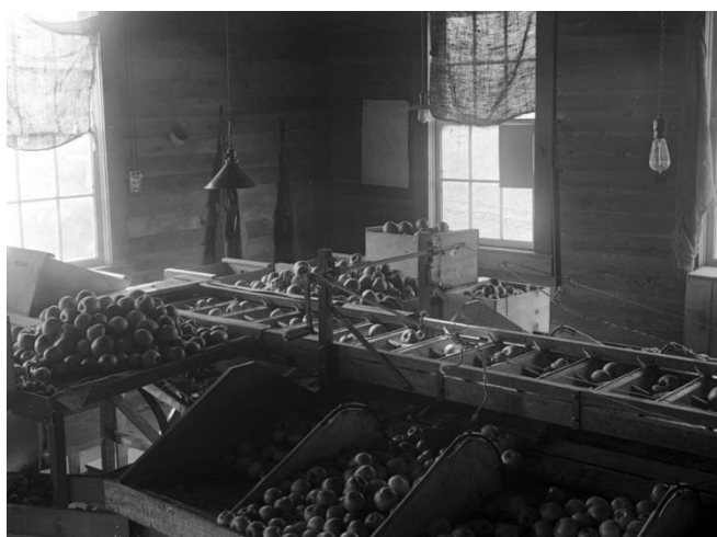
מכונה (סרט נע) למיון תפוחים לפי גודל, שנת 1913. מקור התמונה: History Museum of Hood River County. Cutler Grading Machine, 1913. http://historichoodriver.com/
