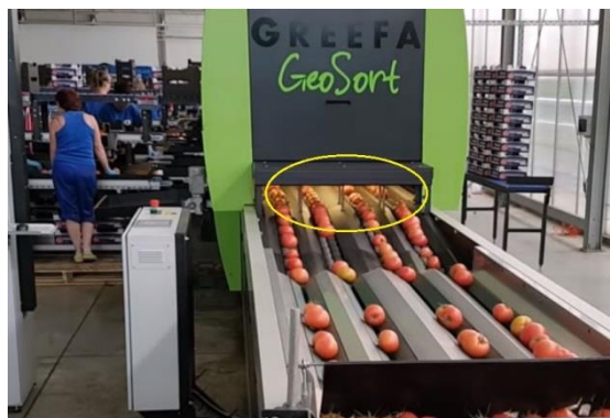
מיון עגבניות אופטי באמצעות צילום בתוך המכונה וחלוקה אריזה בהתאם לקבוצות. מקור התמונה: GREEFA - Kazmierczak - GeoSort 4 grading line for sensitive raspberry tomatoes in Poland. YouTube, July 2016. https://www.youtube.com/
